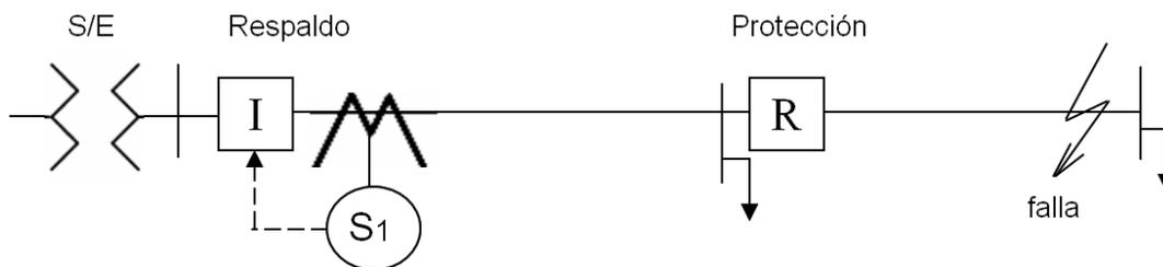
**Figura 12.- Protección de un alimentador radial con Interruptor de MT y Reconectador aguas abajo**
