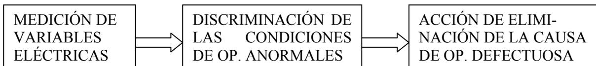
**Figura 1.1 Diagrama de bloques de un sistema de protecciones**
